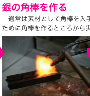
溶けた金属を型に流し込む
