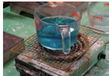
焼きなましをすると表面に酸化膜ができるため、シルバーなどは希硫酸で酸洗い酸化膜を落とす。手順を守って丁寧に作業することが綺麗に仕上げるコツ
