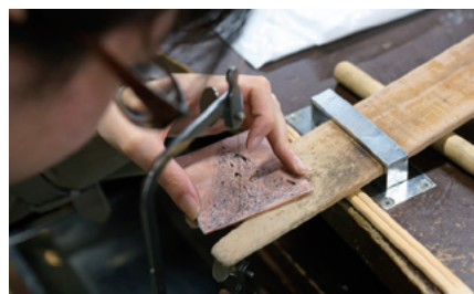
銅板透かしでペンダントを作る。銅板に下絵を描き、糸のこで切り抜いていく。糸のこの確度や力の入れ方など、丁寧に扱わないと糸のこがちぎれてしまう。細かいところやカーブの付いているところは特に慎重に
