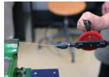
ハンドドリルを使って2種類の金属をねじる。綺麗な縄状になった。このあと曲げてコンビのリングに
