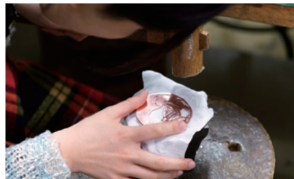
切り抜いたあとは、ヤスリをかけて綺麗にする。表面に模様を付ける場合、金槌や木槌で軽く叩く。使用する道具や台によって模様は変化する。たがねを使って模様を彫り込んでいくこともできる
