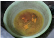
銅や真鍮は、入浴剤の六〇ハップにつけ込むと硫酸と反応して黒い被膜ができ、落ち着いた風合いに
