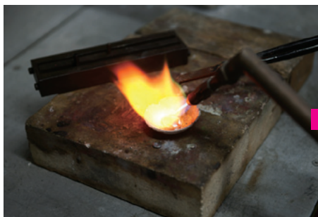
小皿に素材を入れてバーナーで焼いて溶かす
