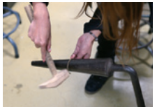
プレスレットを曲げているところ。木の台にあてて過度の大きさになるように曲げていく
