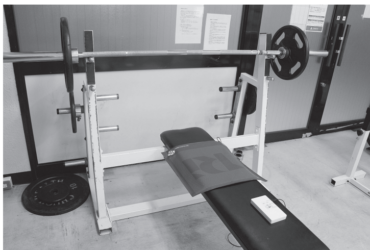
図3 ベンチプレス台に設置したSR ソフトビジョン (数値版) のセンサーシート
