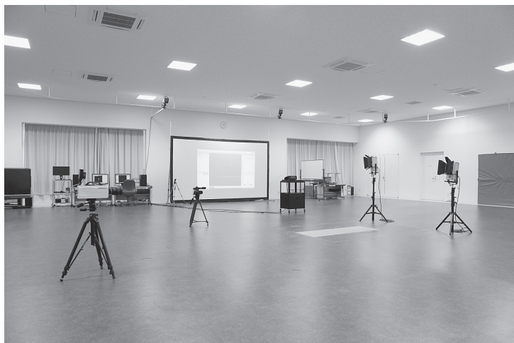
図5. ビデオカメラ10台を使用した三次元動作解析システムの様子
